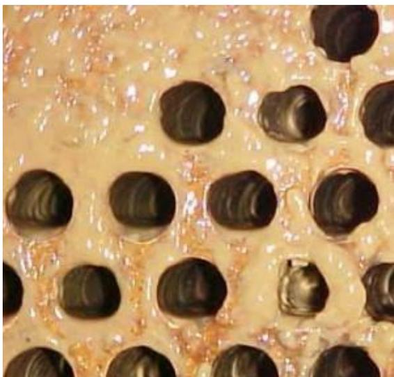
Biofilme em um trocador de calor
